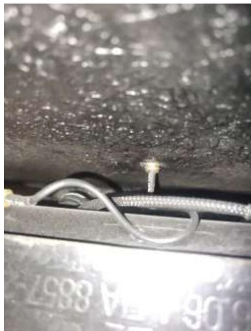
B. Placement du boîtier GPS à l'avant de la voiture juste devant le réservoir.
